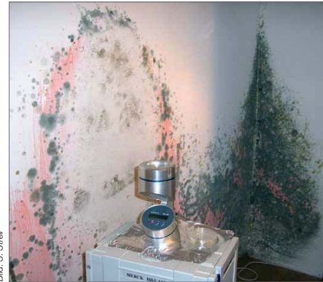
Besonders bei Altbauten häufig eingesetzter Luftkeimsammler, um Zusammensetzung und Menge von Schimmelpilzsporen nachzuweisen.
